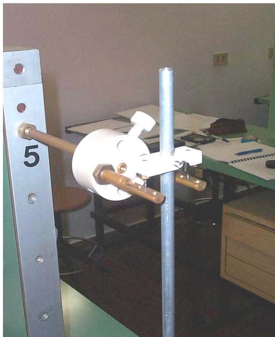
più accurate? Si potrebbe pensare di mettere al posto del filo un'asta metallica. Per rendere le oscillazioni piane si può utilizzare un sistema di sospensione dell'asta costituito da una forcella fissa che sostiene un ponticello munito di bulloncini con punta, come mostra la figura.
